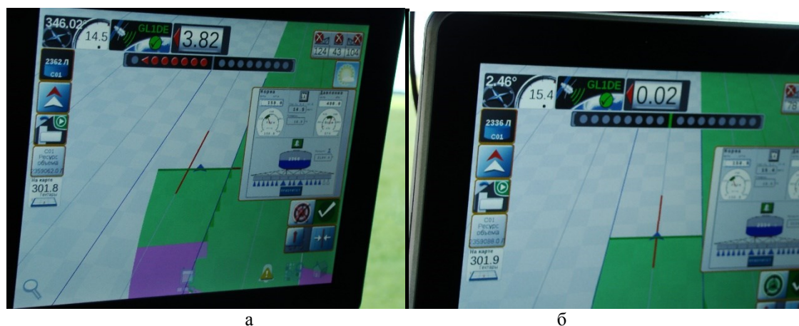
Рис. 2. Система контроля обработки посевов рапса на технологической колее: а) картина на дисплее после прохождения разворота; б) установлен точный проход агрегата по технологической колее (фото Василькина В. М., 2017 г.)
