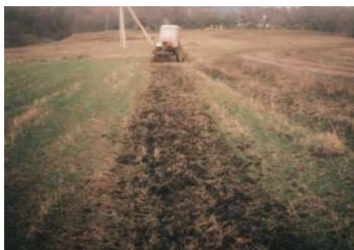
Рис. 6. Общий вид края взрыхленного участка игольчатой бороной БИН-1,8 (двукратный проход), твердость почвы – 3,35 МПа.
