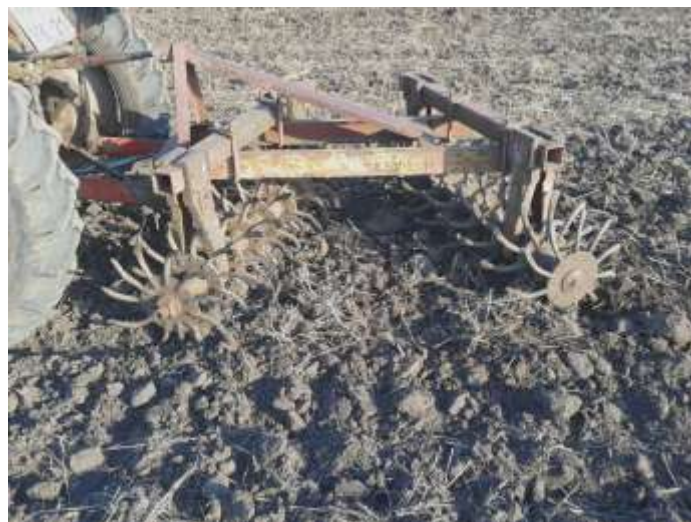
Рис. 3. Повторная обработка игольчатой бороной после стерневой культивации: на переднем плане – участок стерневой культивации; на заднем – участок, повторно обработанный игольчатой бороной.
