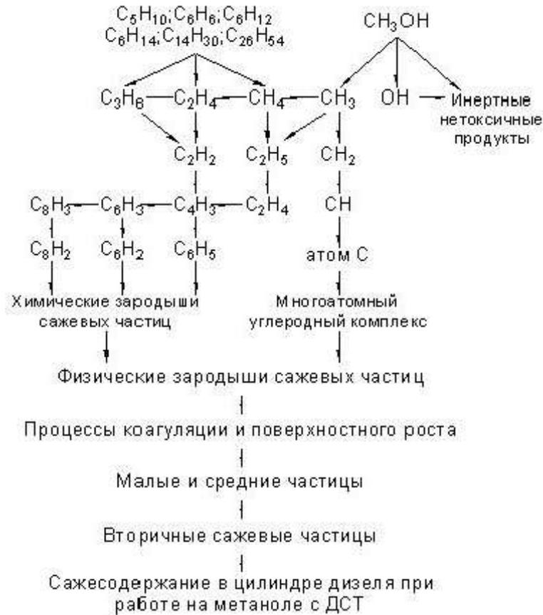
Рис. 1. Процесс образования сажи в цилиндре дизеля 2Ч 10,5/12,0 с полусферической КС в поршне при работе на метаноле с ДСТ и впрыскивании ДТ (запального) через многоструйную форсунку
