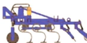
**КБМ-8 ПС-К.** Культиватор блочно-модульный, прицепной (передний опорный каток, пружинная стойка, 3 ряда рабочих органов, планочно-зубовый выравниватель и роторный каток).
