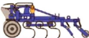
**КБМ-14,4 П «Весенний».** Культиватор блочно-модульный прицепной (пружинная стойка, 3 ряда рабочих органов, планочно-зубовый выравниватель и роторный каток).
