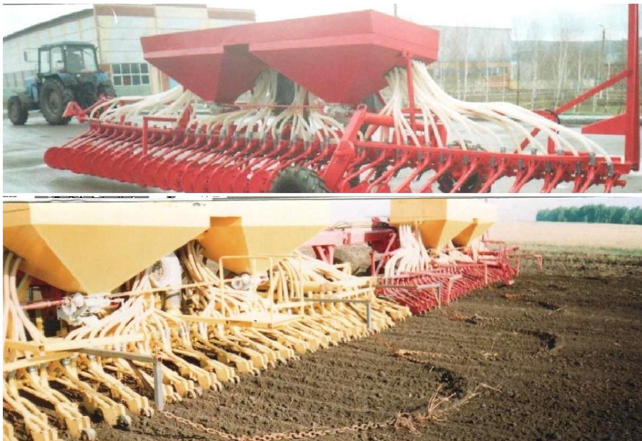
Рисунок 3. Блочно-модульные сеялки: сверху – СПБМ-8; снизу – СПБМ-16.
