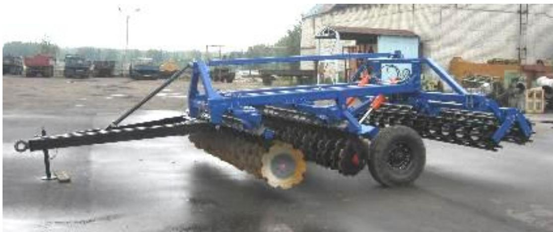
Рисунок 16. Машина для основной обработки почвы – «Бизон».
