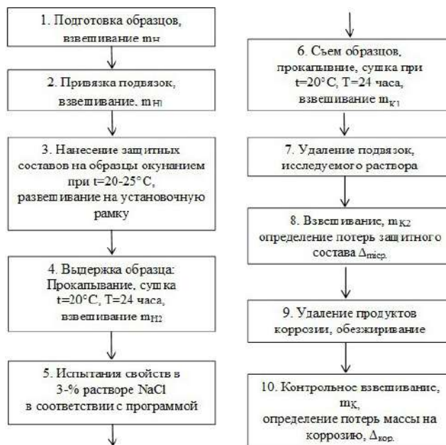
Рис. 1. Схема испытаний противокоррозионных свойств невысыхающих составов
