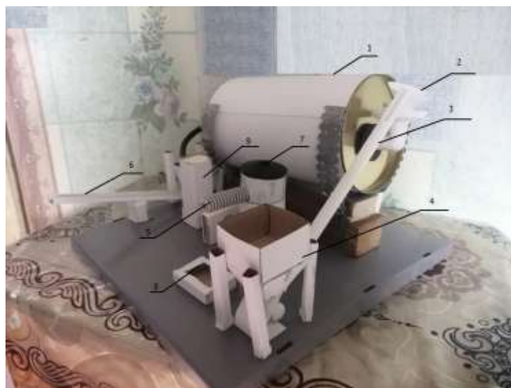
Рис. 1. Внешний вид физической модели биоферментатора: 1 – биореактор; 2 – приемная воронка; 3 – шнековый транспортер; 4 – загрузочный бункер; 5 – трубопровод для выхода воздуха; 6 – винтовой транспортер; 7 – система очистки газового выброса; 8 – приемная емкость для жидкого удобрения; 9 – сепаратор.
