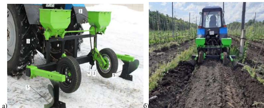
Рис. 7. Трансформер в режиме окучника (а – общий вид: 1 – рама; 2 – ящики; 3 – опорное колесо; 4 – регулировочный винт; 5 – корпус; 6 – грядиль; 7 – кронштейн; б – окучивание рядов хмеля с одновременным внесением удобрений)
