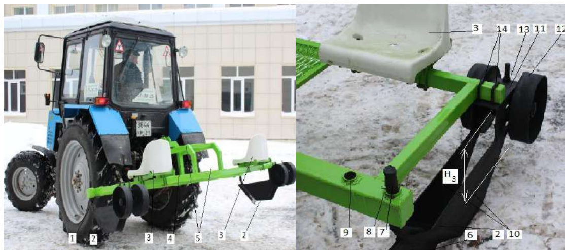
Рис. 5. Двухрядный посадчик черенков хмеля (а – общий вид; б – посадочное устройство: 1 – рама; 2 – сошник; 3 – сиденья; 4 – навесное устройство; 5 – платформа для ящиков; 6 – лезвия; 7 – поводок; 8,9 – отверстия; 10 – боковины; 11 – задняя опора; 12 – катки; 13 – винт; 14 – стремянки)
