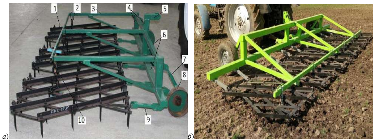
Рис. 3. Бороновальный агрегат с шириной захвата в 3,0 м (а); 6,0 м (б):
