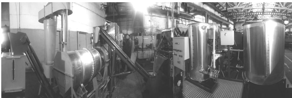
Рис. 3. Универсальная технологическая линия по производству гуминовых жидких и сухих удобрений
