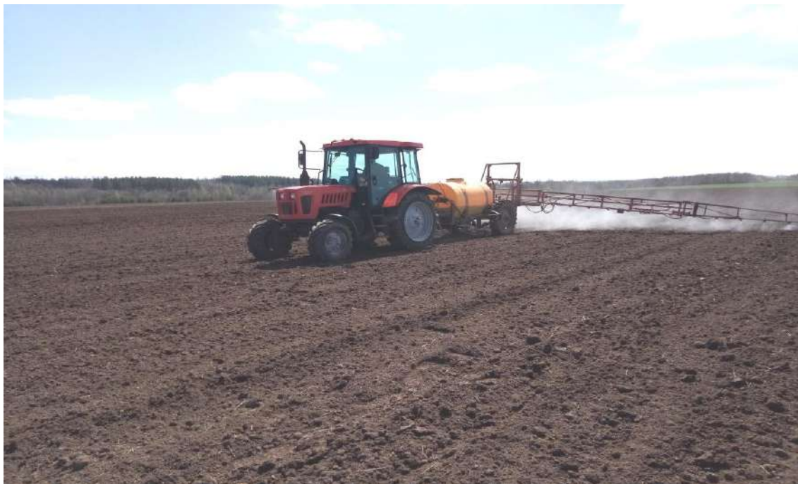
Рис.1. Предпосевное внесение «Востока ЭМ-1» с помощью опрыскивателя ОП-2500 в агрегате с колесным трактором МТЗ-82
