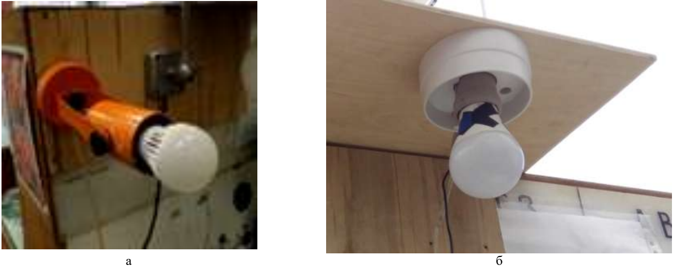
Рис. 2. Положение ламп в процессе эксперимента: а) – горизонтальное, б) – вертикальное колбой вниз
