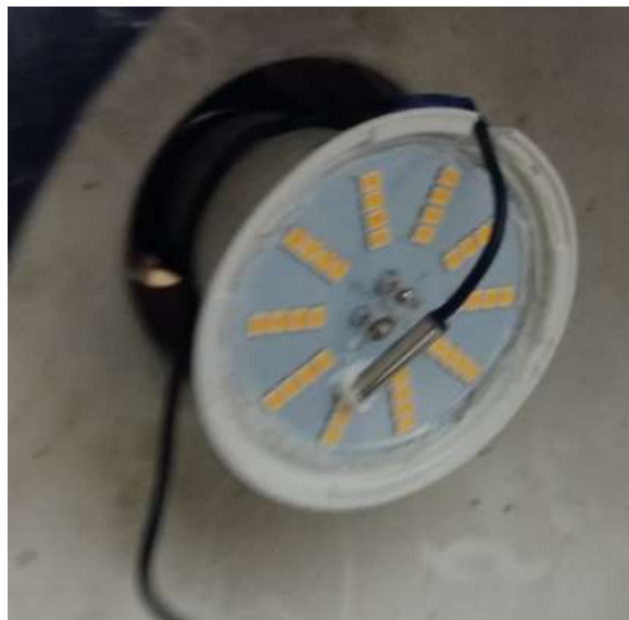
Рис. 6. Установка датчика температуры на светодиод
