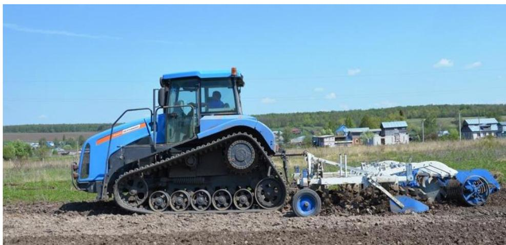
Рис.3. Трактор Агромаш – Руслан со стерневым культиватором Агромаш КСУ 500 на полях Канашского района Чувашской Республики
