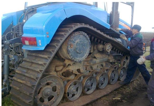
Рис.1. Плановое обслуживание трактора Агромаш-Руслан на испытательном полигоне.
