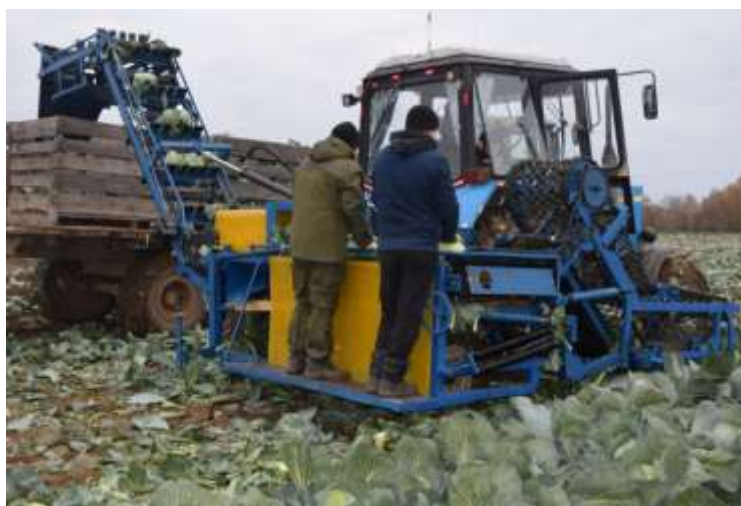
Рис. 2. Испытания нового отгрузочного устройства в составе опытного капустоуборочного комбайна
