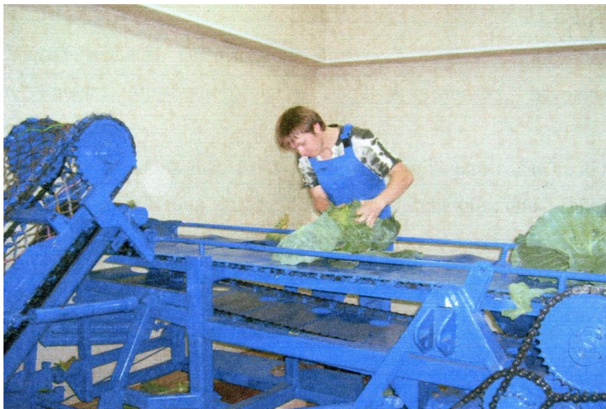
Рис. 4. Исследование процесса доработки кочанов капусты на транспортере – обрезчике
