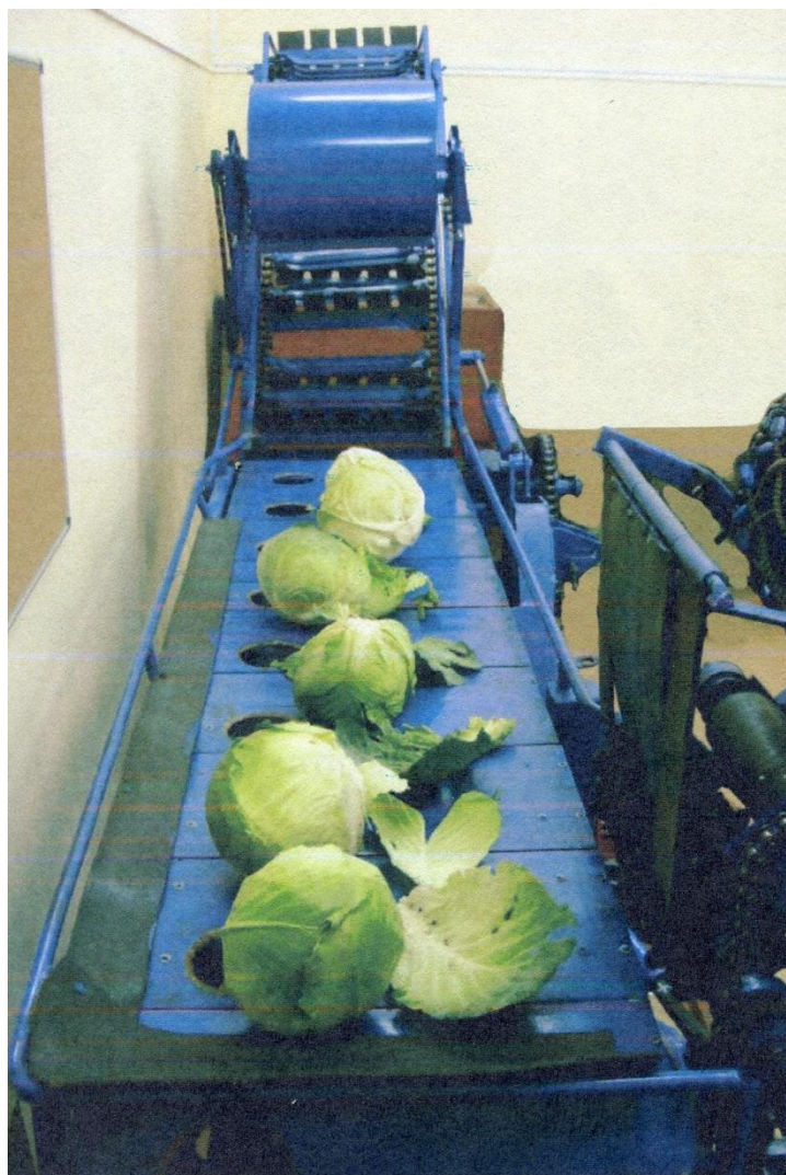
Рис. 5. Исследование процесса сепарации вороха капусты в капустоуборочном комбайне в лабораторных условиях
