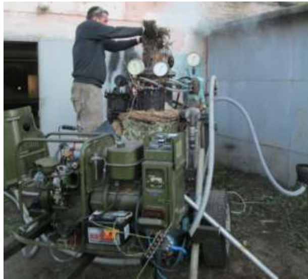
Рис. 1. Загрузка в газогенератор навоза КРС
