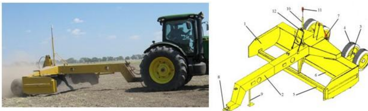
Рис. 1. Внешний вид скрепера-планировщика: 1 – боковая стенка; 2 – рама; 3 – мост; 4 – колеса; 5 – рыхлитель; 6 – лезвие ножа; 7 – гидроцилиндр; 8 – сница; 9 – опорная стойка; 10 – телескопическая мачта; 11 – лазер (или GPS-приемник); 12 – лестница.
