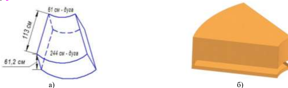
Рис. 2. Резонатор в виде радиального сегмента коаксиального цилиндра: а) с указанием размеров; б) пространственное изображение
