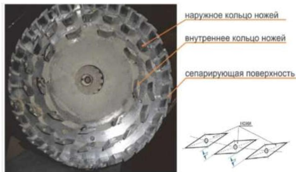
Рис. 2. Общий вид верхнего диска измельчителя с сепарирующей поверхностью и установленными ножами и схема контроля открытия сепарирующей поверхности
