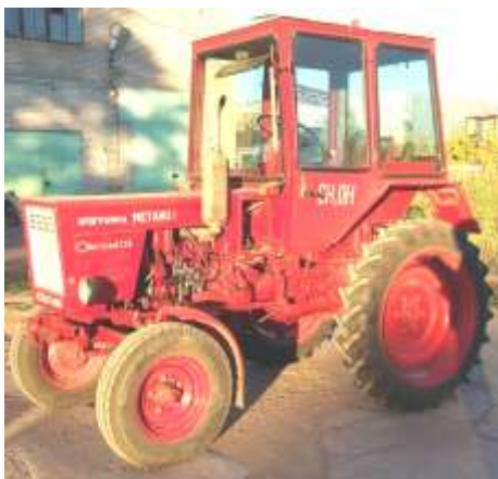
Рис. 1. Общий вид трактора Т-25А с системой питания, модернизированной для работы метаноле с двойной системой топливоподачи
