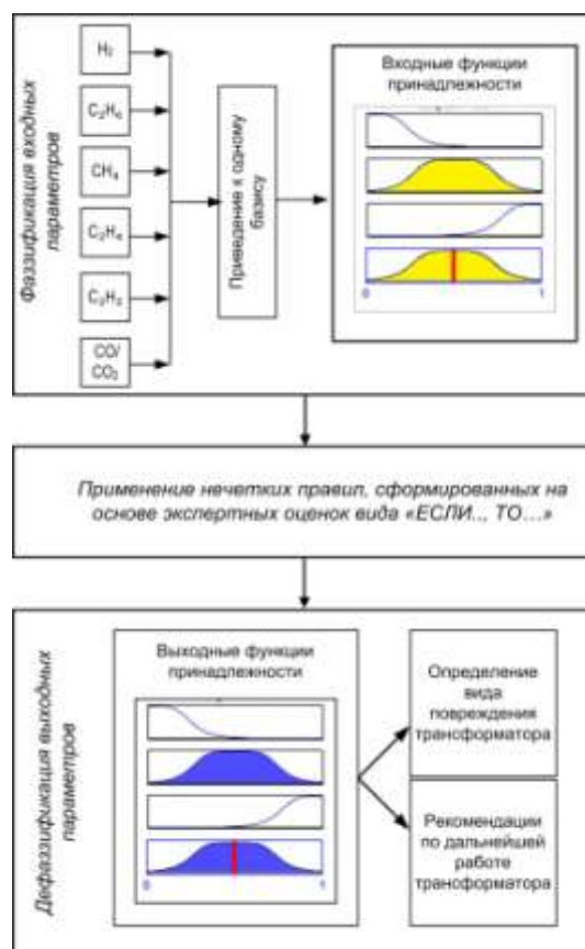
Рис.7. Алгоритм диагностирования состояния трансформатора с помощью нечеткой логики
