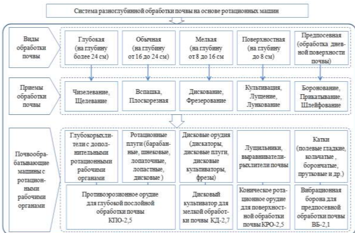
Рис. 3. Классификация почвообрабатывающих машин с ротационными рабочими органами в системе разноглубинной обработки почвы
