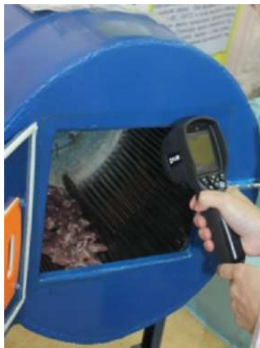
Рис. 2. Установка для термообработки и массирования субпродуктов (патент № 2650540)
