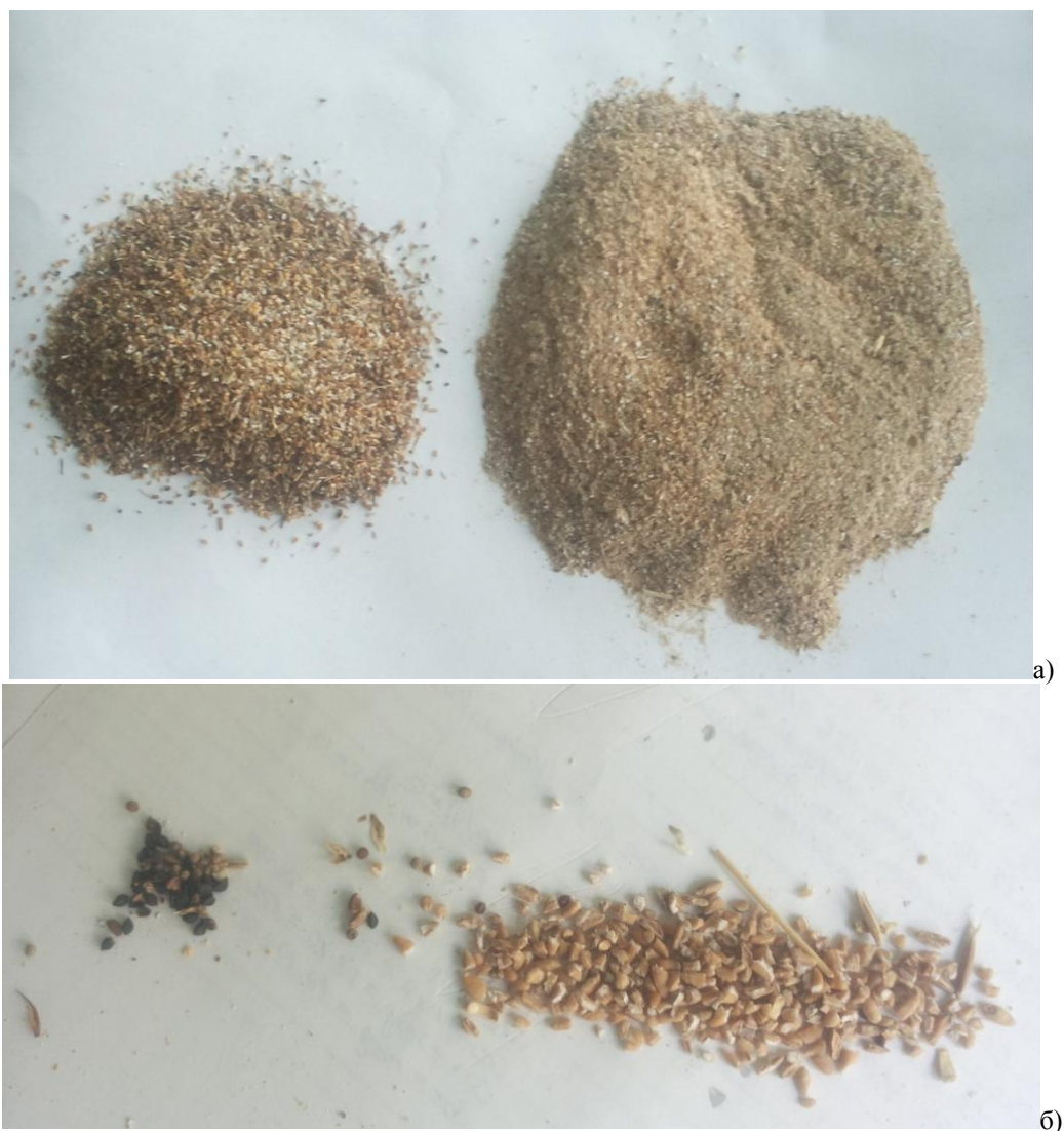
Рис. 2. Фракции 1,0-1,3 мм (слева, а) и 0-1,0 мм (справа, а) и фракция 1,3-1,5 мм с разделением неразрушенных семян лебеды (слева, б) и основной культуры (справа, б) после двукратного размола с усовершенствованным измельчающим ротором
