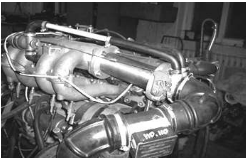
Рис. 4. Общий вид двигателя с установленной модернизированной впускной системой
