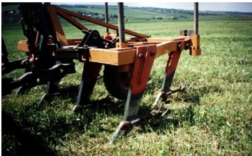
Рис. 2. Подпокрывной рыхлитель РП-2,4 для основной обработки почвы тракторами класса 3
