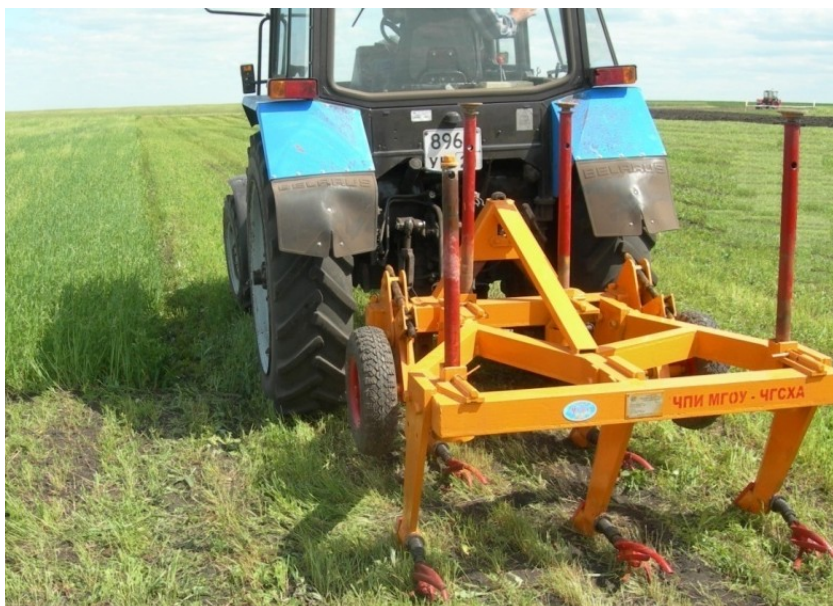
Рис. 3. Подпокрывной рыхлитель РП-1,7 для основной обработки тракторами класса 1,4 и 2
