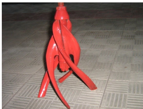
Рис. 1. Рабочий орган реактивного действия для подпокрывного рыхления почвы
